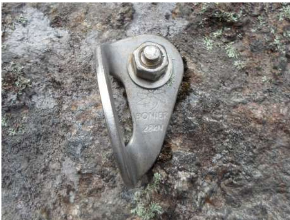
Chapa con perno de anclaje y 'Abrazadera P' fabricado y utilizado en Brasil.
